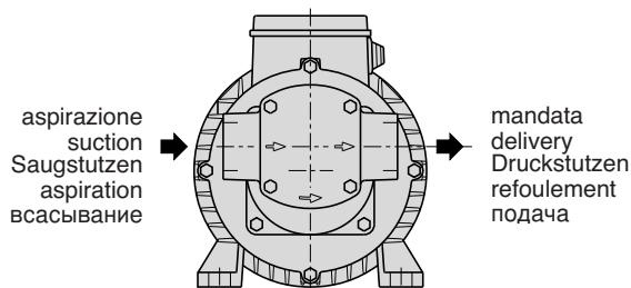
Sul corpo pompa visto frontalmente, la bocca di aspirazione si trova a sinistra e la bocca di mandata a destra.
