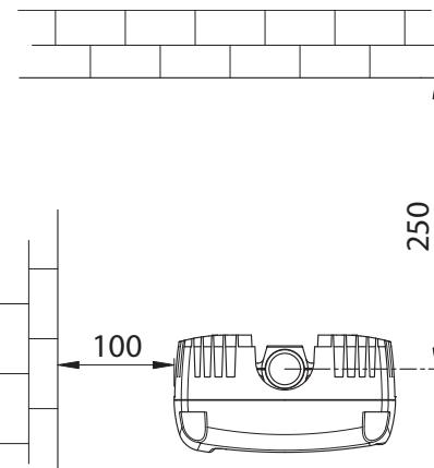
Nel caso le distanze risultino inferiori collegare il variatore di frequenza mediante appositi bocchettoni (vedere paragrafo 16.3.).
