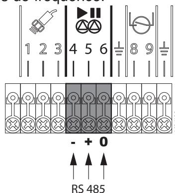
**!** Vérifier que la réalisation du câblage est respectée et que les extrémités de chaque câble sont connectées à la borne du même numéro.
