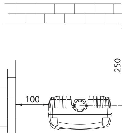
En el caso que las distancias fueran inferiores conectar el variador de frecuencia mediante las boquillas especiales (véase el párrafo 16.3.).
