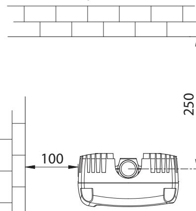
Au cas où les distances seraient inférieures, brancher le variateur de fréquence au moyen des raccords prévus à cet effet (voir paragraphe 16.3.). Ne pas installer l'armoire dans des lieux exposés à la lumière directe du soleil ou proches de sources de chaleur. Monter le bloc aluminium (a) au tuyau de refoulement de la pompe à l'aide des berceaux (b1-b2) et des vis (c) fournis.
